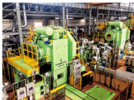
モーターによる自動制御とコンパクト化を同時に実現した新ローリングミルライン
