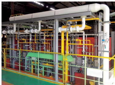
バーナを導入した鋼材熱処理炉（写真奥）と、炉側面に組付けられたバーナ・配管（写真手前）（刈谷工場）
