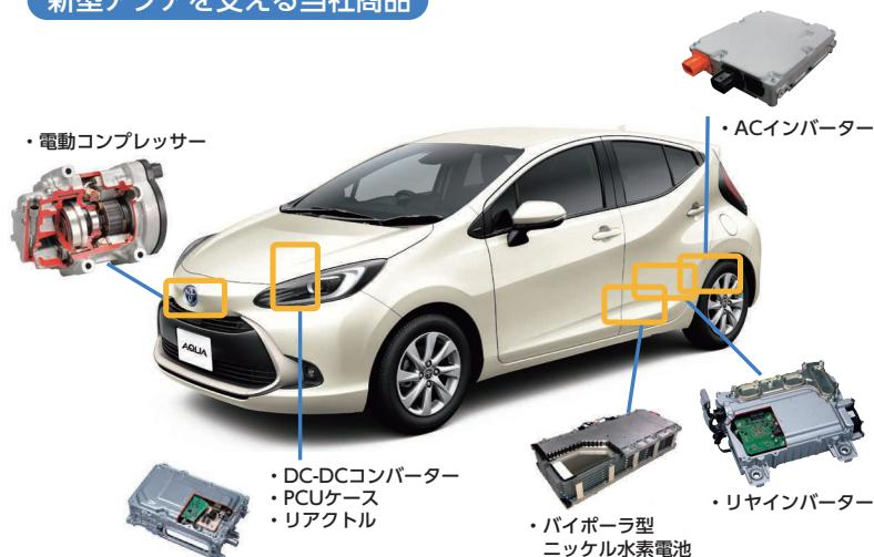
材料探索から製品設計・評価まで一貫した開発を行っている強みを活かし、従来型比較で高出力を実現し、パワフルな走行に貢献しています。電池に加え、快適な車室内空間を実現する電動コンプレッサの他、最適な電力を供給するDC-DCコンバーター・ACインバーターなどの車載電源系商品が搭載されています。
