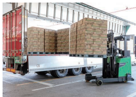
トラック荷役対応自動運転フォークリフト（4本フォークタイプ）
