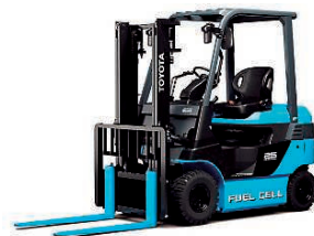
新型燃料電池フォークリフト2.5t積タイプ
