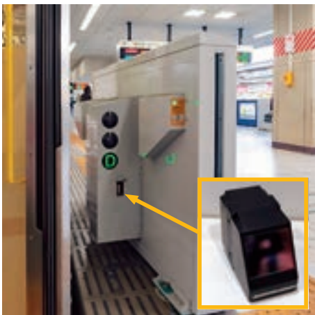
ホームドアセンサ（3D距離画像センサ）
