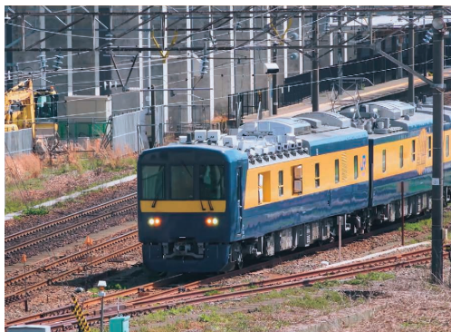
「Trario車上ユニット」総合検測車
