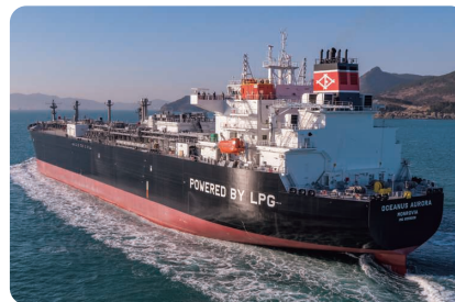
アンモニアを積載可能なLPG二元燃料主機関搭載 VLGC OCEANUS AURORA 91,000m 3
